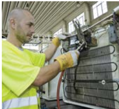
Odsávání freonu z lednice
